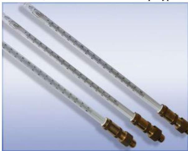
Рисунок 1 - Общий вид термометров стеклянных для испытаний нефтепродуктов ТН4 М
