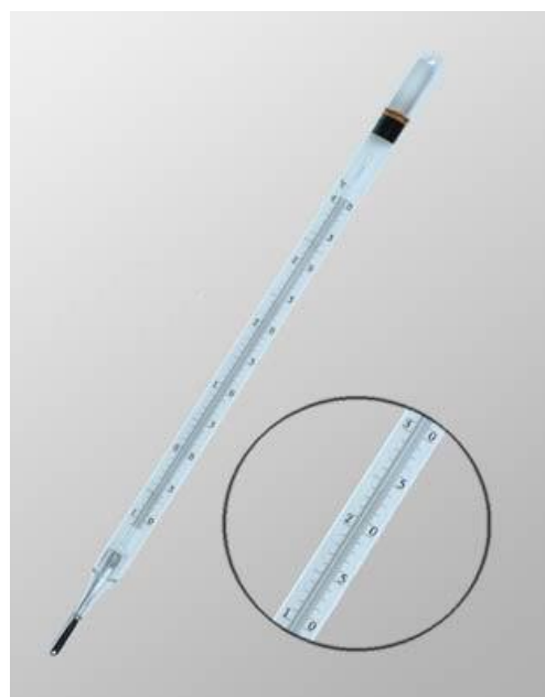
Рисунок 1 – Общий вид термометров метеорологических стеклянных
