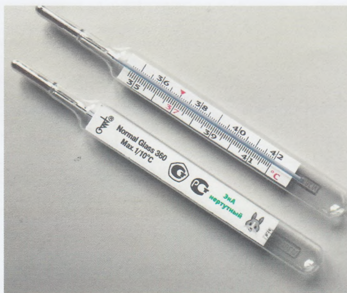
Рисунок 1 - Термометр медицинский максимальный стеклянный ЭКА (нертутный)
