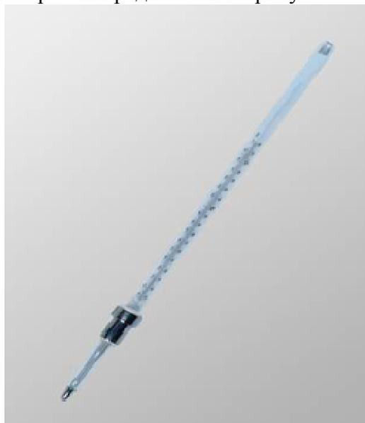
Рисунок 1 - Общий вид термометров стеклянных для испытания нефтепродуктов ТН-1
